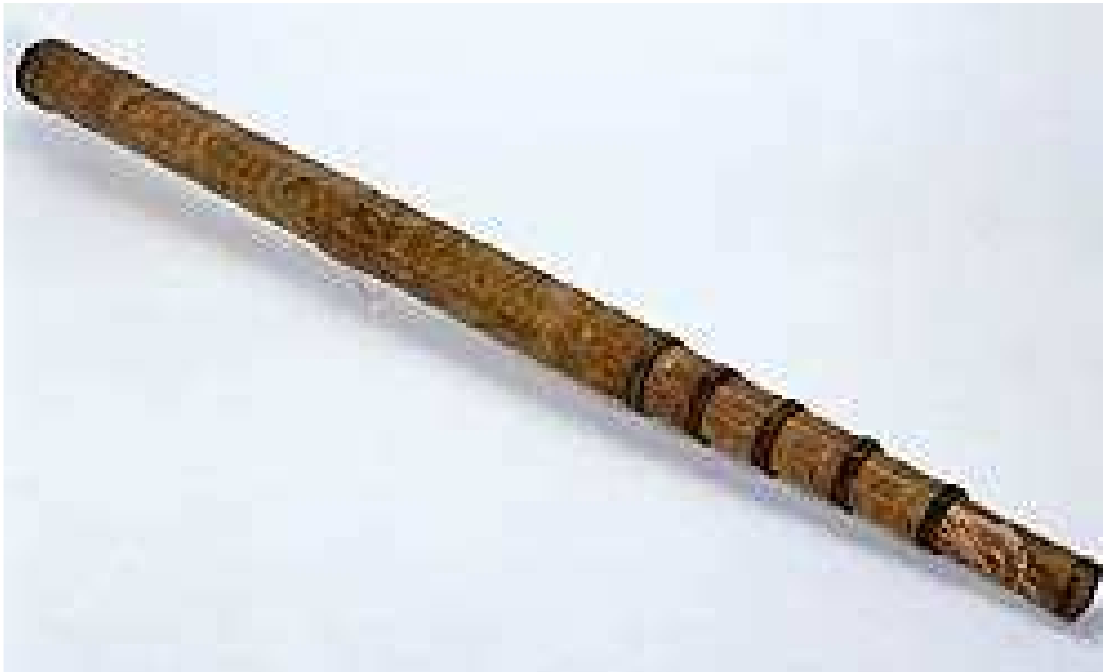
Cannocchiale ottagonale 1664 Legno, cartone, carta fiorentina Lunghezza 2980 mm
