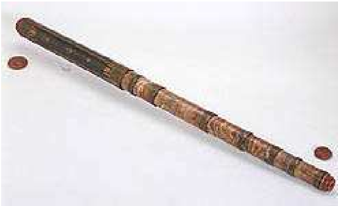
Cannocchiale c. 1664 Cartone, pelle Lunghezza 2250 mm
