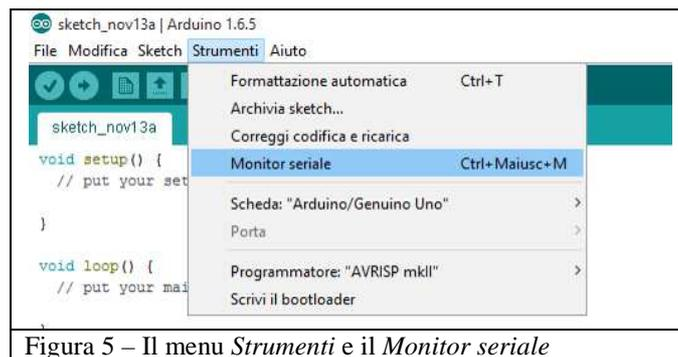
Figura 5 – Il menu *Strumenti* e il *Monitor seriale*
