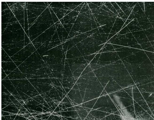
Fig. 3.2 Traiettorie di particelle in una camera a nebbia
