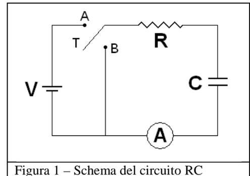
Figura 1 – Schema del circuito RC
