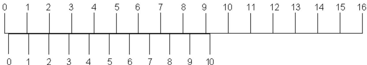
In generale la tacca del nonio che coincide con la tacca della scala superiore ci dice di quale frazione dell'unità della scala superiore lo zero del nonio è spostato rispetto all'unità. Per esempio, nella figura sotto lo zero del nonio si trova tra l'1 e il 2 della scala superiore, mentre la tacca del nonio che coincide con quella superiore è il 4, questo significa che i due zeri distano 1,4 unità della scala superiore.
