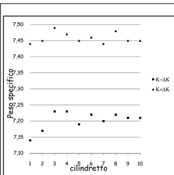
Figura 10 - Riportando in un grafico, per ogni cilindretto, il valore di  $k-\Delta k$  e di  $k+\Delta k$ , si può osservare che esiste un intervallo comune e che quindi le determinazioni di  $k$  (densità) sono compatibili.
