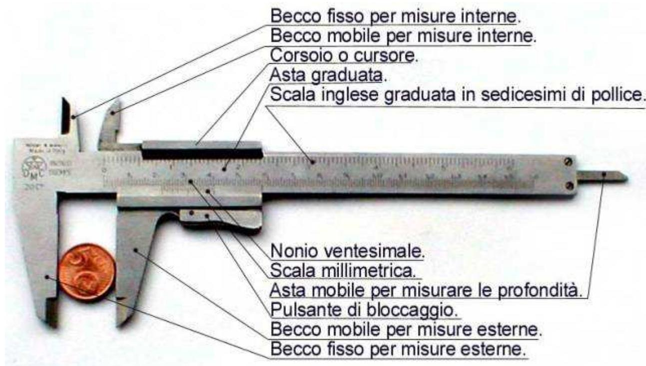
Il calibro è costituito da un'asta graduata fissa e da un cursore mobile, con le quali si può stringere un oggetto. Sulla parte fissa c'è una scala in centimetri, con divisioni di un millimetro, mentre sulla parte mobile detta **nonio** c'è un'altra piccola scala che serve ad aumentare di molto la sensibilità di lettura, anche di qualche decimo di millimetro.
