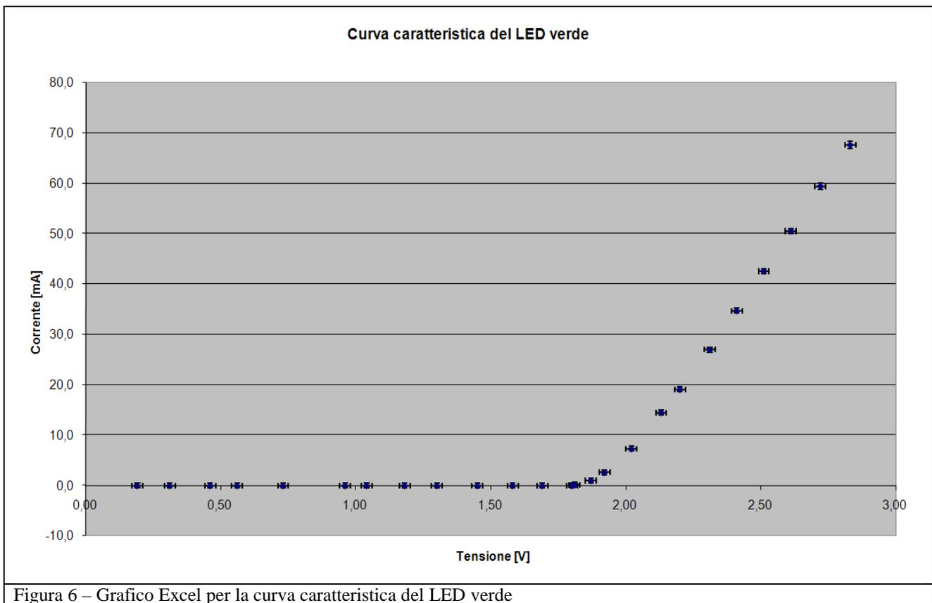
Figura 6 – Grafico Excel per la curva caratteristica del LED verde
