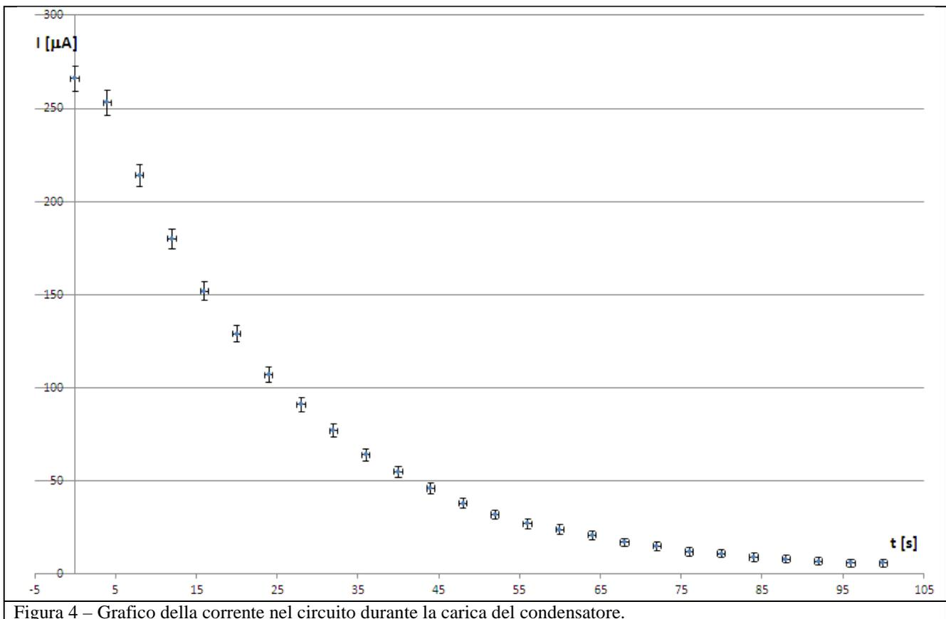
Figura 4 – Grafico della corrente nel circuito durante la carica del condensatore.
