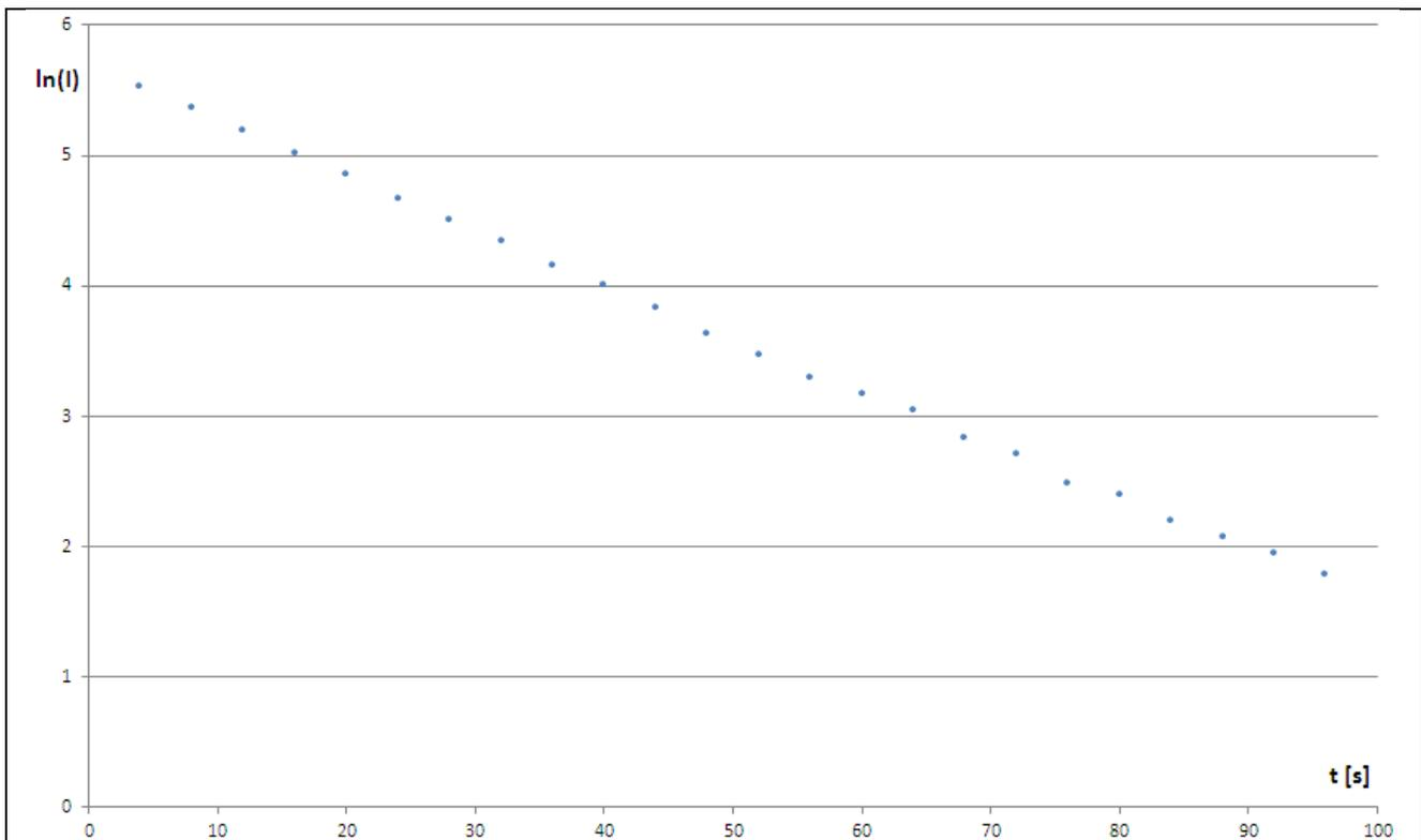
Figura 6 – Grafico del logaritmo della corrente in funzione del tempo
