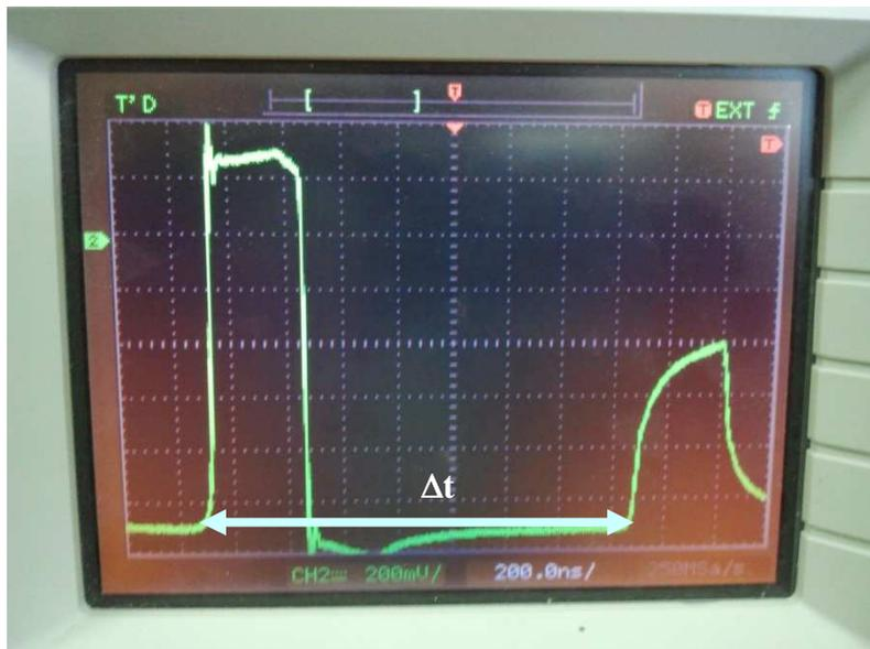
Fig. 7 Impulso diretto e riflesso sul display dell'oscilloscopio
