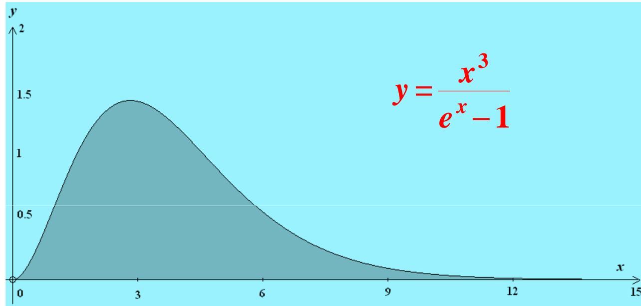
Integrando su tutte le frequenze si ottiene l'energia per unità di volume  $u = aT^4$ , con  $a = \frac{8\pi^5 k^4}{15c^3 h^3} = 7,536 \cdot 10^{-15} \text{ erg/m}^3$  (legge di STEFAN, 1879). Il massimo della funzione obbedisce alla legge  $\lambda_{\text{MAX}} T = \text{costante} = 0,2898 \text{ cm} \cdot \text{K}$  (legge di WIEN).
