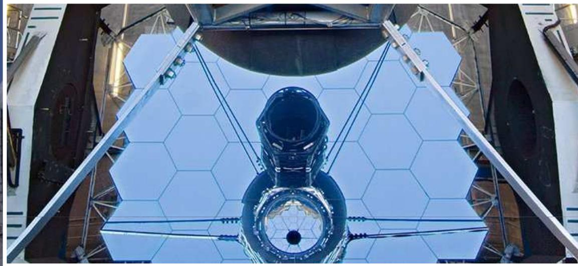
I due telescopi sono di tipo Ritchey-Chrétien, con montatura altazimutale e sistemi di ottica attiva e adattiva. Lo specchio primario di ciascuno dei due telescopi è costituito da un insieme di specchi esagonali assemblati in modo da formare uno specchio equivalente ad uno di 10,2 m di diametro,
