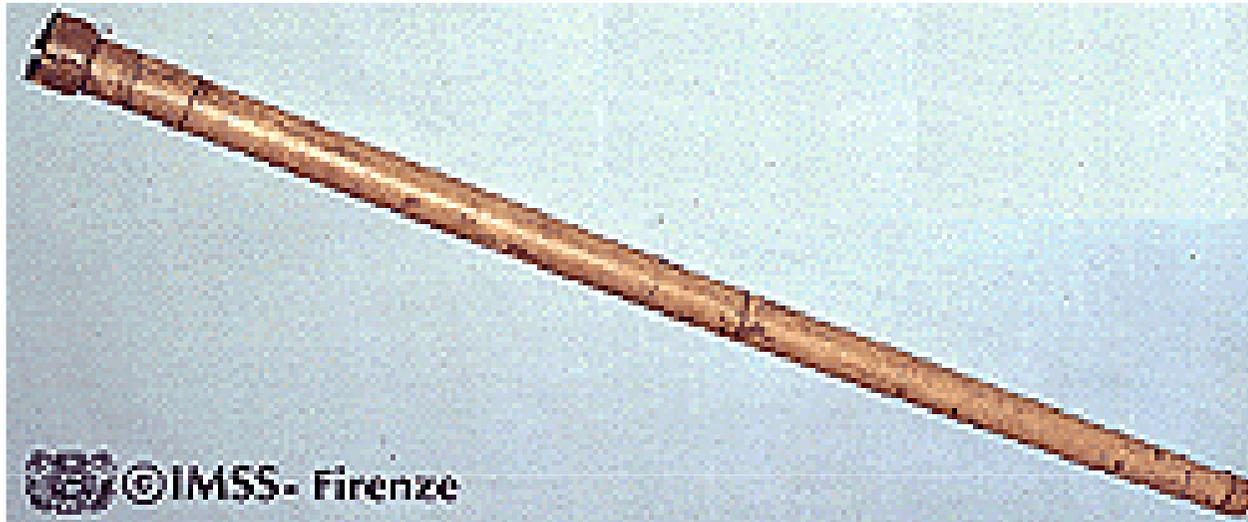
Il tubo di legno ricoperto di carta, contiene una lente obbiettivo biconvessa e un oculare piano concavo. Ha capacità di ingrandimento di 14 volte. La lente obbiettivo di questo cannocchiale ha distanza focale di 1330mm e apertura utile di 26mm.
