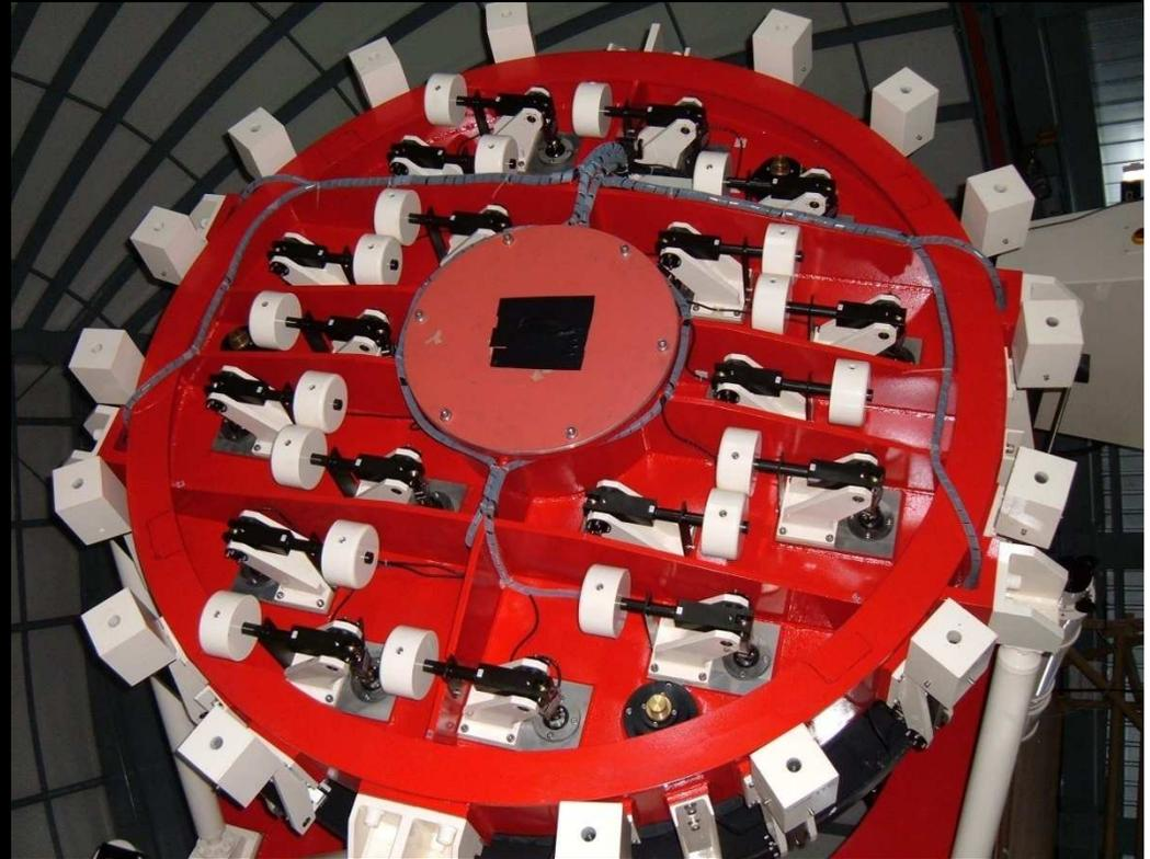
Gli specchi primari dei moderni telescopi riflettori, che hanno diametri dai 3 agli 8 metri o più, non sono in grado di reggere il proprio peso senza deformarsi.
