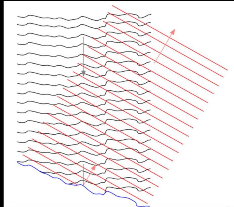
Il fronte d'onda proveniente dalla sorgente viene distorto dalle turbolenze atmosferiche, la conoscenza della forma effettiva del fronte d'onda permetterebbe, tramite un sistema di specchi a deformazione controllabile, di recuperare una forma più simile a quella piana, precedente l'interazione con l'atmosfera, migliorando drasticamente la qualità dell'immagine.
