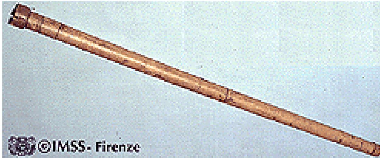
Il tubo di legno ricoperto di carta, contiene una lente obbiettivo biconvessa e un oculare piano concavo. Ha capacità di ingrandimento di 14 volte. La lente obbiettivo di questo cannocchiale ha distanza focale di 1330mm e apertura utile di 26mm.
