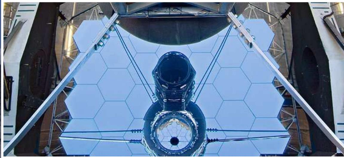
I due telescopi sono di tipo Ritchey-Chrétien, con montatura altazimutale e sistemi di ottica attiva e adattiva. Lo specchio primario di ciascuno dei due telescopi è costituito da un insieme di specchi esagonali assemblati in modo da formare uno specchio equivalente ad uno di 10,2 m di diametro,
