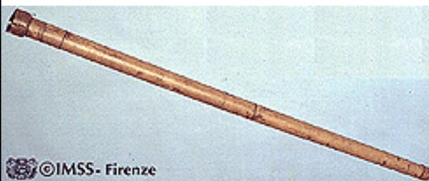
Il tubo di legno ricoperto di carta, contiene una lente obbiettiva biconvessa e un oculare piano concavo. Ha capacità di ingrandimento di 14 volte. La lente obbiettiva di questo cannocchiale ha distanza focale di 1330mm e apertura utile di 26mm.
